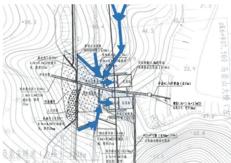
图 8.4-6 乌岩尖隧道进口排水 (P3 段) (蓝色: 排水沟汇至蓄水池中)
